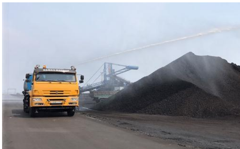
Рис. 2.10. Автоцистерна с насосной установкой и оборудованием для орошения на шасси грузового автомобиля КаМАЗ
