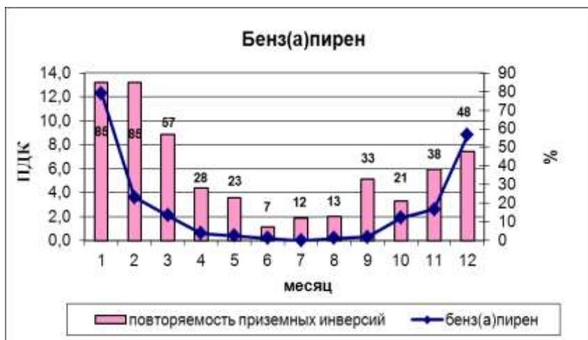
Рисунок 2.3. График годового хода среднемесячных концентраций бенз(а)пирена и повторяемости приземных инверсий в целом по рп. Чегдомын, 2020 год
